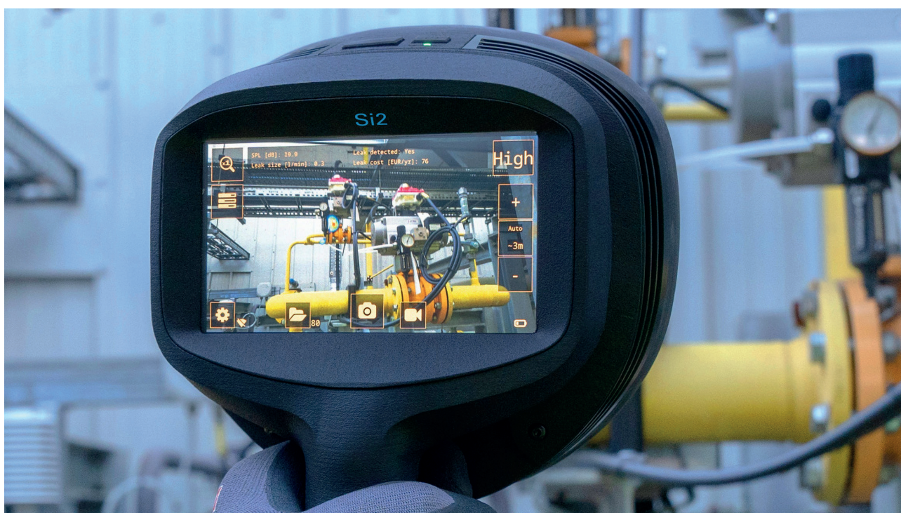
Imager acustico sul campo, FLIR Si2, per il rilevamento delle perdite, che calcola le dimensioni e il costo delle perdite.
