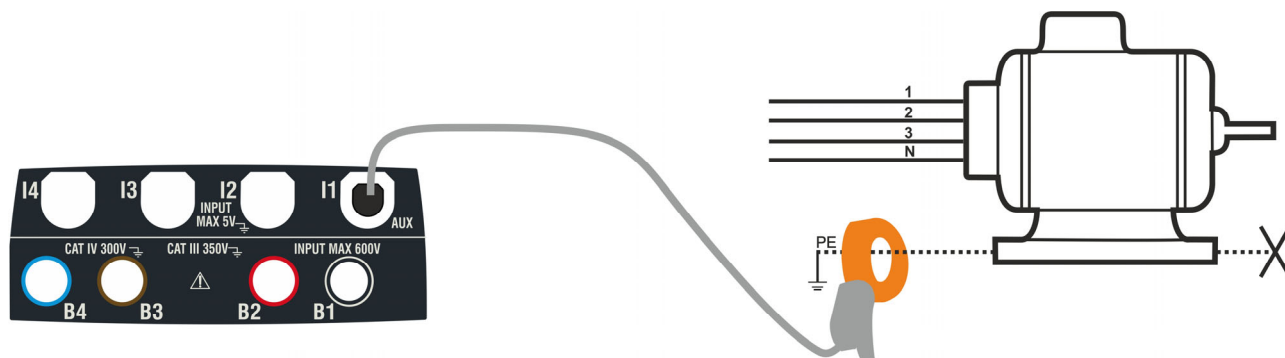
Fig. 7: Misurazione diretta della corrente di dispersione in impianti trifase
