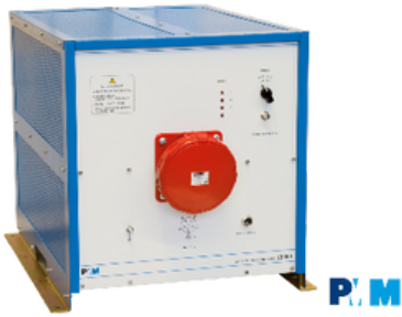
L3-100 LISN 100 A, TRE FASI PIÙ NEUTRO 9 kHz – 30 MHz
